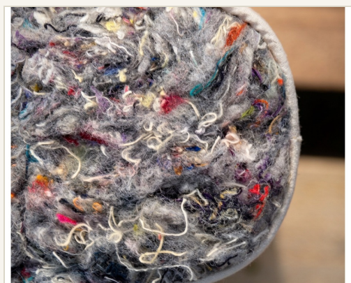
Tværsnit: kernen er bygget af genanvendt tekstilfiber.
